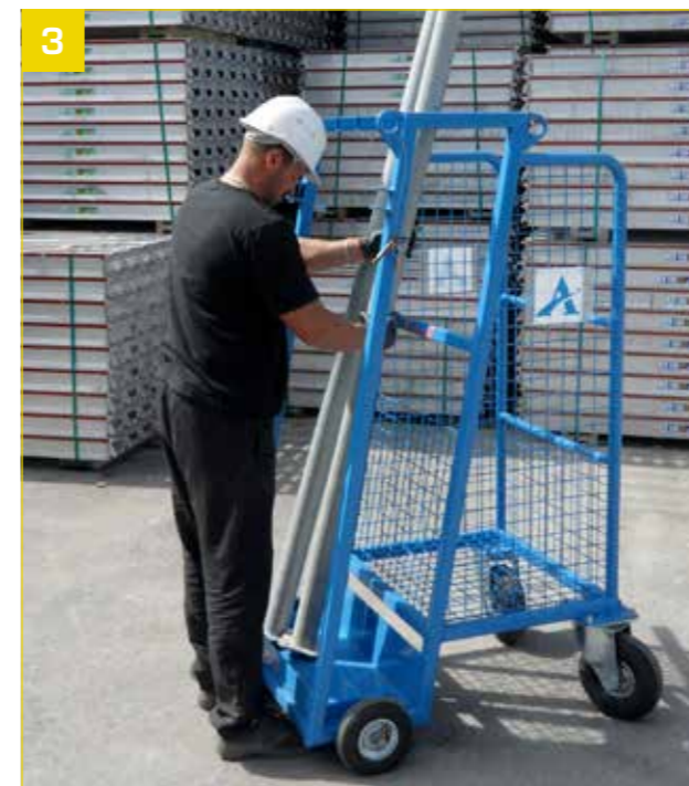
- Posicionamento das escoras no carro de transporte.
