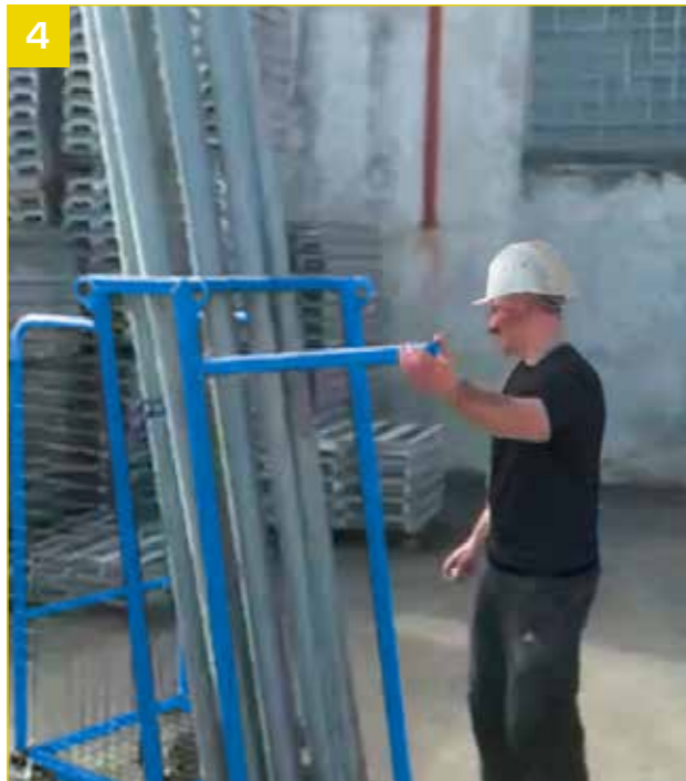
- Travamento do carro de transporte
