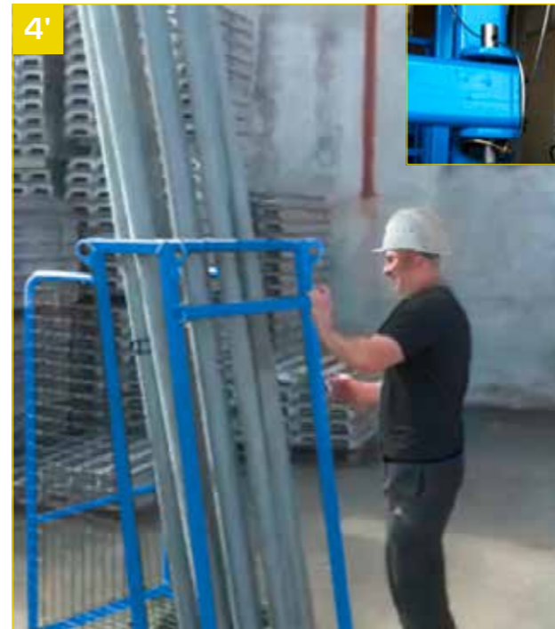
- Travamento por meio de perno imperdível
