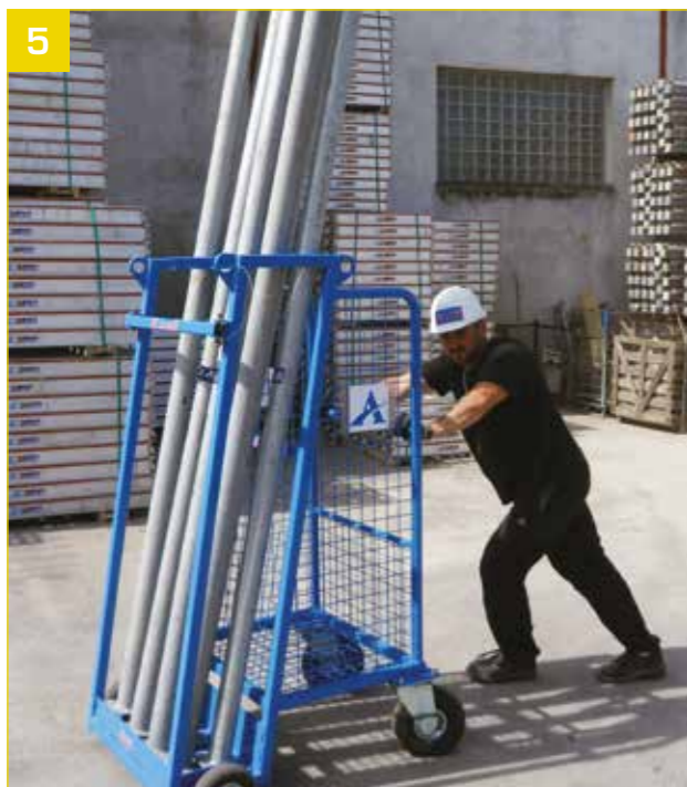
- Deslocamento do carro de transporte: a barra ergonómica permite o deslocamento manual do TransÉtais.
